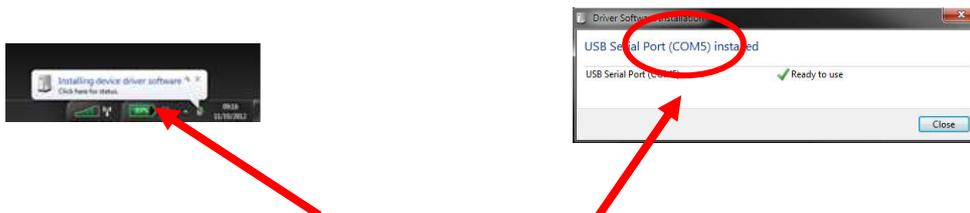
Una volta connesso il cavo USB la finestra di sinistra confermerà che windows sta cercando il driver. Cliccando su tale finestra è possibile seguire l'installazione (vedi finestra sulla destra). Al termine dell'installazione viene indicata la porta COM associata al cavo (COM5 in questo caso).
